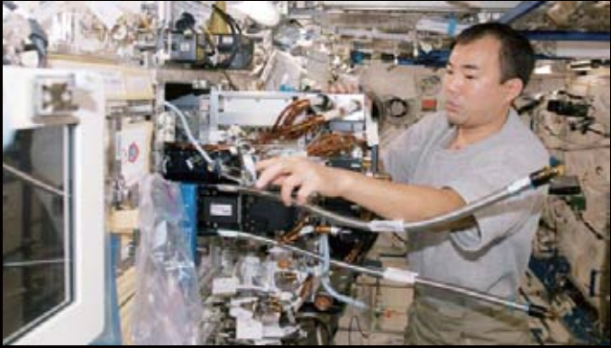
「きぼう」日本実験棟で、流体物理実験装置を用いて行うマランゴニ対流実験の準備を行う野口宇宙飛行士。マランゴニ対流というのは表面張力の差によって起こる対流で、地上では重力の影響があるため、実験を行うことが難しい。
