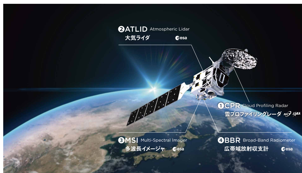
観測方式の異なる4種類のセンサを搭載した「はくりゅう(EarthCARE)」
