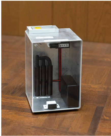
雪氷モニタリングセンサのモックアップ。
